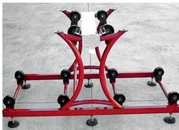
Slitta per inserimento barriques - Insert slide tool
